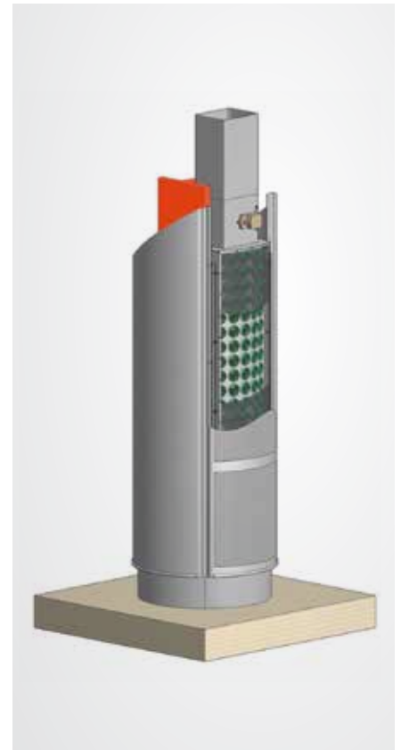
Einstellbarer Quellluftdurchlass für Heiz- und Kühlbetrieb
