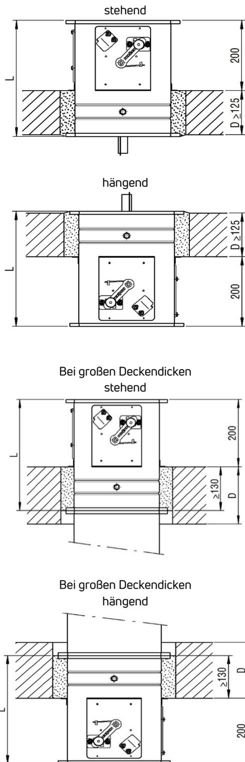
Abbildung 8: Einbaulagen in massiven Decken
