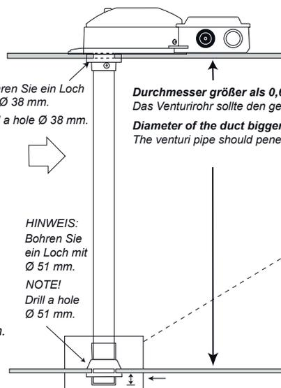
Bohren Sie ein Loch mit  $\varnothing$  38 mm.
