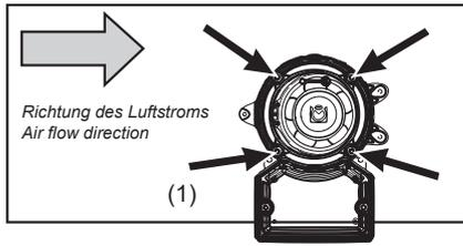
1. Lösen Sie die vier Schrauben.
