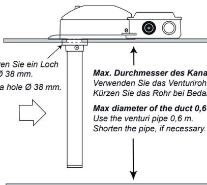
Bohren Sie ein Loch mit  $\varnothing$  38 mm.
