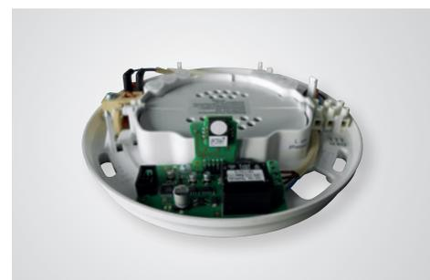
Abb. 3: WFA mit Auswerteelektronik
