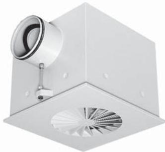
RA Größe 2 mit Dralldurchlass Typ DA, DN 315. Flanschmaß 500 bis 625 mm.
