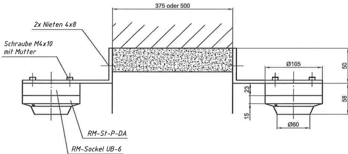
*Rauchmelder Befestigung/Einbau/Verbund mit Absperrvorrichtung "BK-EI90S"*
