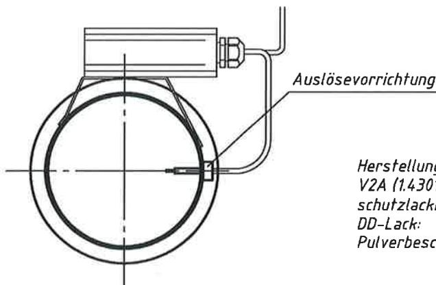
Herstellung der Absperrvorrichtung auch aus Edelstahl der Typen V2A (1.4301) / V4A (1.4571) bzw. oberflächenveredelt oder schutzlackiert mit den Schichtdicken wie folgt:
