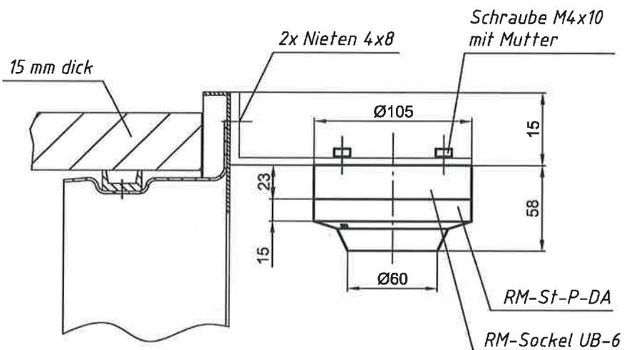
*Rauchmelder Befestigung/Einbau/Verbund mit Absperrvorrichtung Typ BR*
