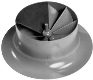
Mit Hilfe der Flügelabdeckungen aus Recticel kann die Ausblascharakteristik im Hinblick auf die horizontale Ausblasrichtung verändert werden, z. B. um die minimalen Mittenabstände zwischen 2 Durchlässen oder den Wandabstand zu reduzieren.
