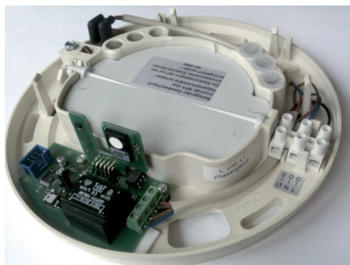
Abb 2: VOC-Sensor mit Feuchte- und Temperatursensor (links)
